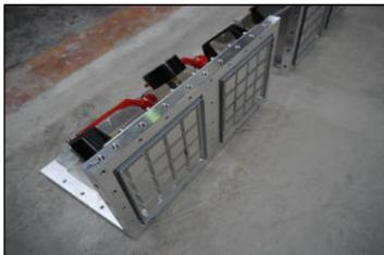
Die Abschalvorrichtung des Vakuum-Winkelspanners mit Saugvorrichtung.
