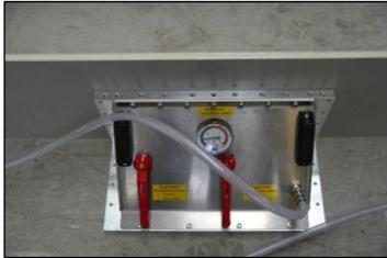
Das neue Abschalssystem – der Vakuum-Winkelspanner VWS - für Fertigteilwerke funktioniert mit Unterdruck und kann beliebig auf der Schalung positioniert werden.
