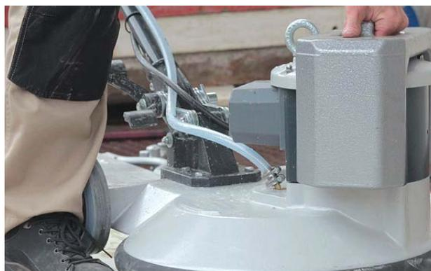
Um das Schleifgut aus dem Reinigungsbereich zu spülen und das Reinigungspad und Schleifgitter sauber zu halten wird mit Wasser gereinigt.
