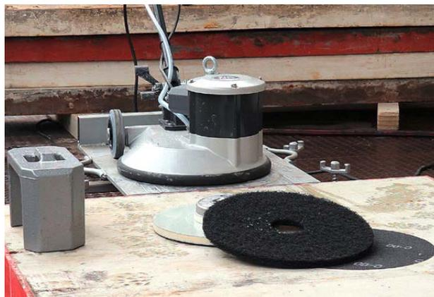
Die Effizienz der Reinigung mit einem Rotationsreiniger kann durch ein Zusatzgewicht verbessert werden.
