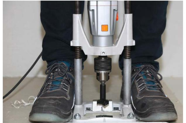
Zylinderkopfbohrer Ø 35 in Bohrmaschine einsetzen. Vor dem Bohren Bohrtiefe (6 mm) überprüfen.
