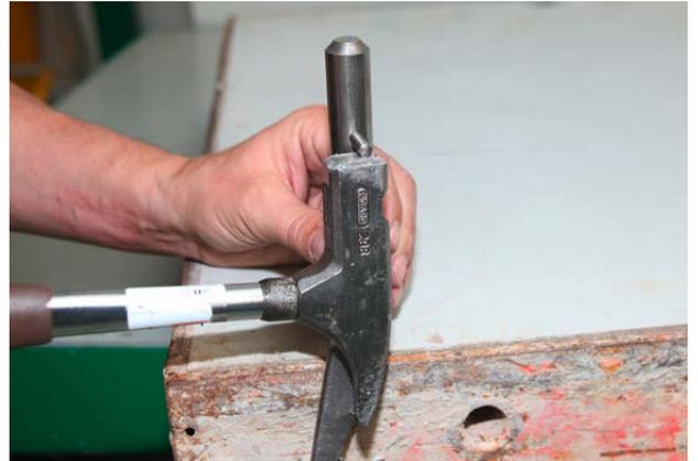
Neue Niete einsetzen und mit Nietgerät montieren.
