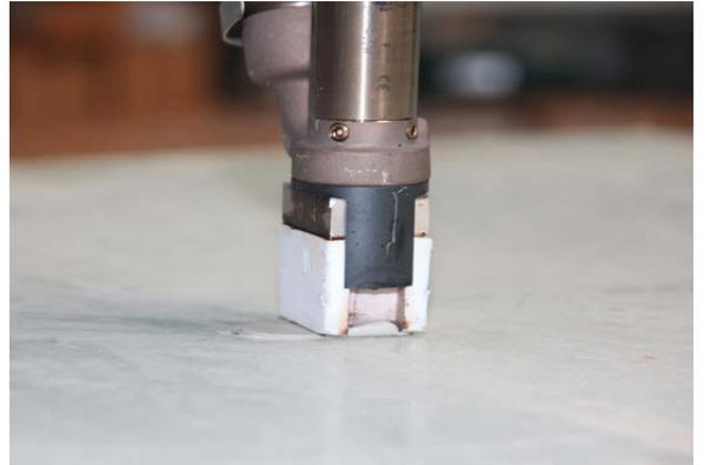
Oberfläche im Reparaturbereich mit Lackfräse plan bearbeiten.
