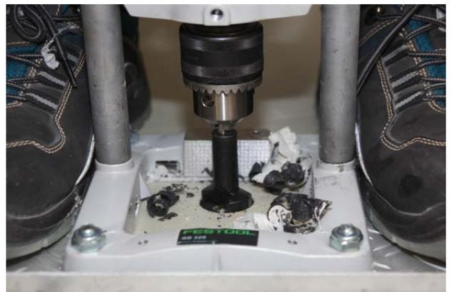
Reparaturplatte Ø 35 (Dicke 6,5 mm) mit Fase nach oben einlegen.
