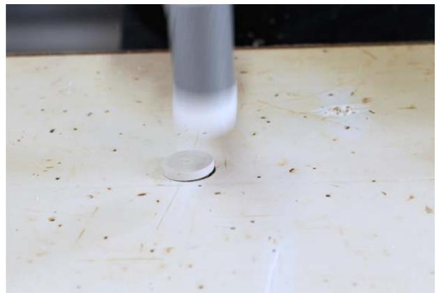
Der verbleibende Überstand wird wie bei der Reparatur von Kratzern einfach mit Lackfräse und Farbkratzer abgezogen. Die Stopfen bestehen wie die Platte selbst aus Polypropylen. Somit kann auch eine künftige Beschädigung im Bereich eines Stopfens einfach mit dem Extruder repariert werden.
