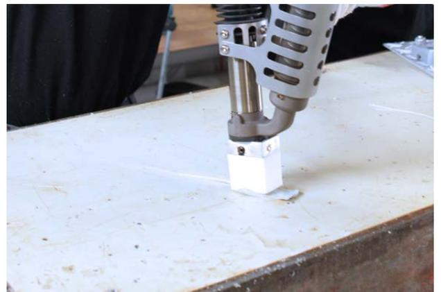
Überstehendes Material wird mit der Lackfräse abgetragen und ...
