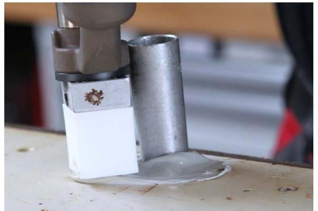
Nach dem Entfernen des Reparaturkonus wird die reparierte Stelle mit Lackfräse und Farbkratzer abgezogen.
